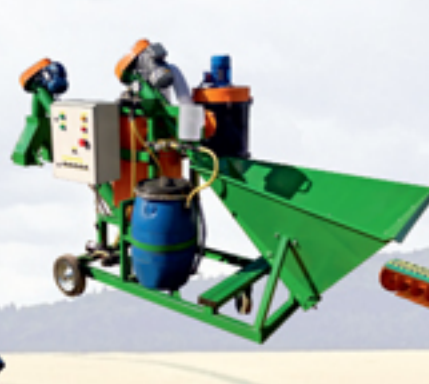
ПРОТРАВЛИВАТЕЛЬ СЕМЯН МПС-8 Производительность до 8 т/ч
