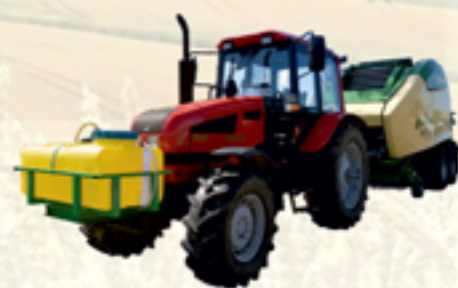
ОБОРУДОВАНИЕ для внесения консерванта на пресс-подборщик
