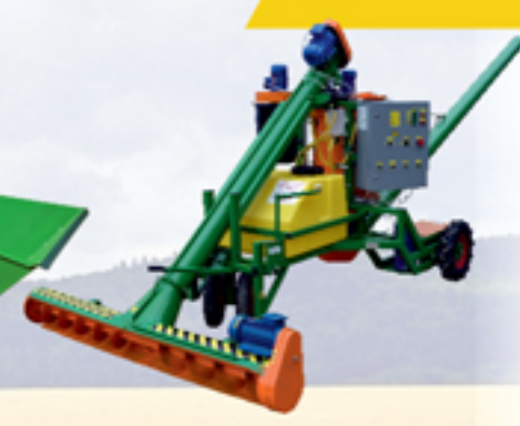
ПРОТРАВЛИВАТЕЛЬ СЕМЯН ПСК-15 Производительность до 20 т/ч
